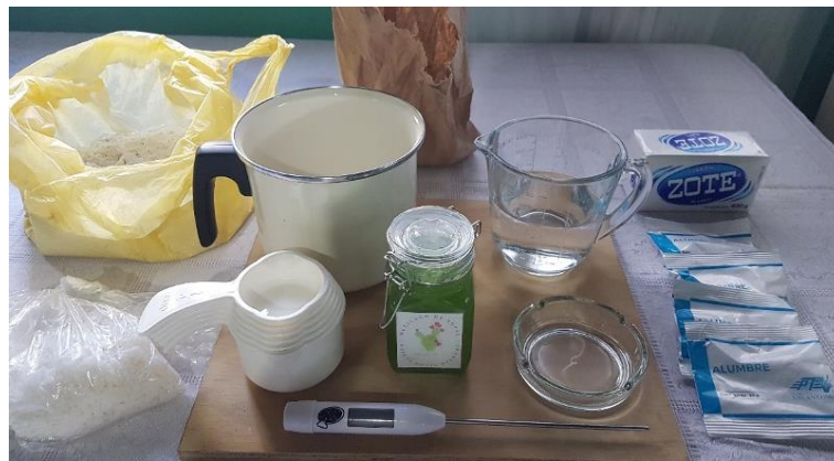
Figura 10 Materiales y equipo empleados para la elaboración del impermeabilizante a base de mucilago de nopal
