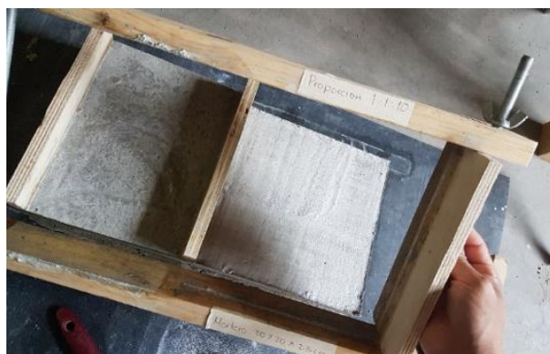
Figura 6 Descimbrado de probetas de mortero
