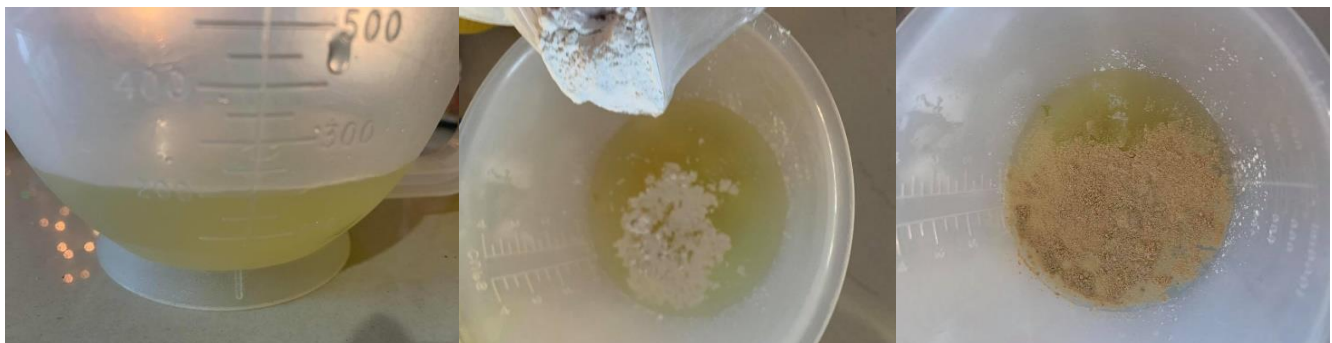
Figura 4 Componentes de impermeabilizante tradicional con base a cal y mucilago
