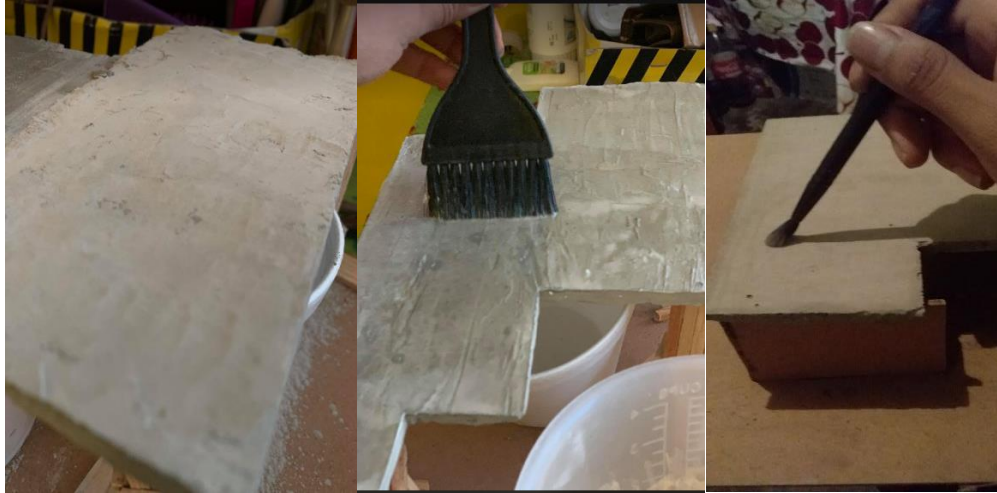
Figura 2 Elaboración de probetas (concreto) para ensaye de impermeabilizante
