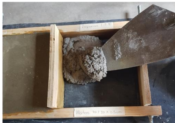
Figura 5. Vaciado de la mezcla de cemento-cal-arena
