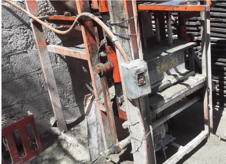
Figura 6 Vibrado de las mezclas para fabricar los bloques
