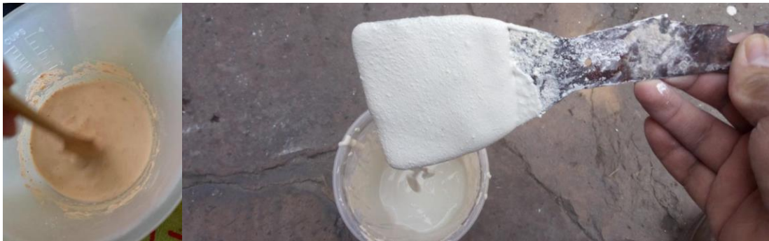
Figura 3 Dosificación de impermeabilizante tradicional a base de cal
