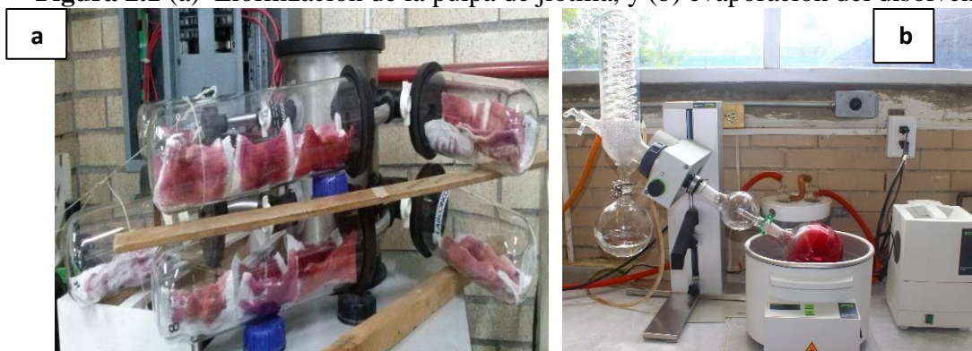
Figura 2.1 (a) Liofilización de la pulpa de jiotilla, y (b) evaporación del disolvente
