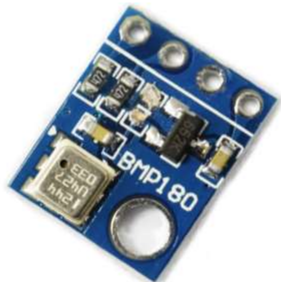
Figure 3 Sensor de presión barométrica con compensación de temperatura_BMP180. (2023)
