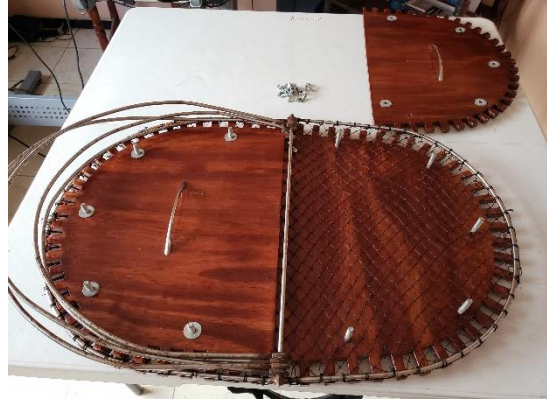
Figura 13 Colocación de Red en bastidor para costura
