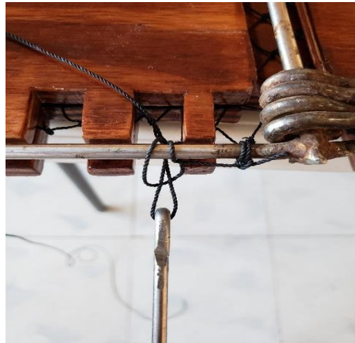
Figura 14 Realización de nudo con aguja de acero
