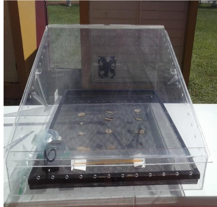
Figura 1 a) Secador solar directo con convección forzada y b) Secado a cielo abierto
