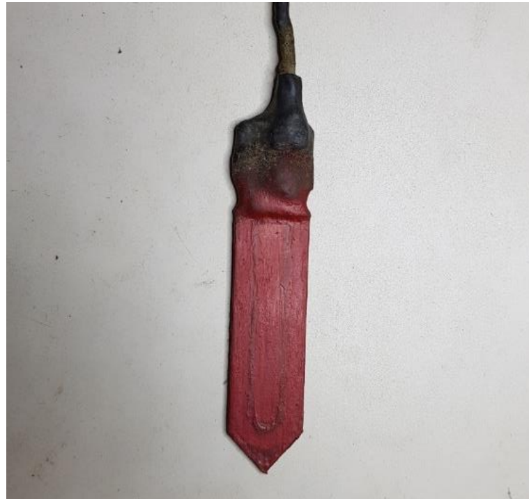
Figura 12. Propuesta de mejora, sensor CSM cubierto por hule. Fuente: autoría propia
