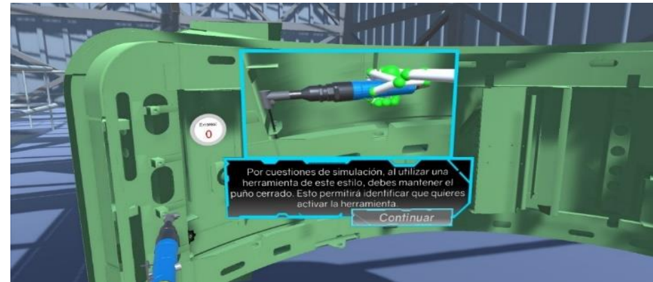
Figura 10 Módulo de instalación de puertas con taladro 90 a grados ( Favela, 2019 )
