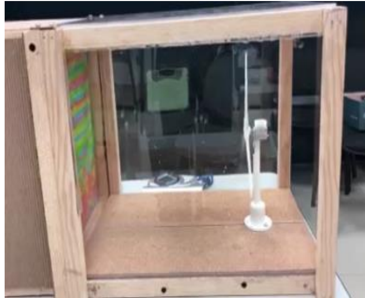
Figura 5 Cámara de pruebas del túnel de viento
