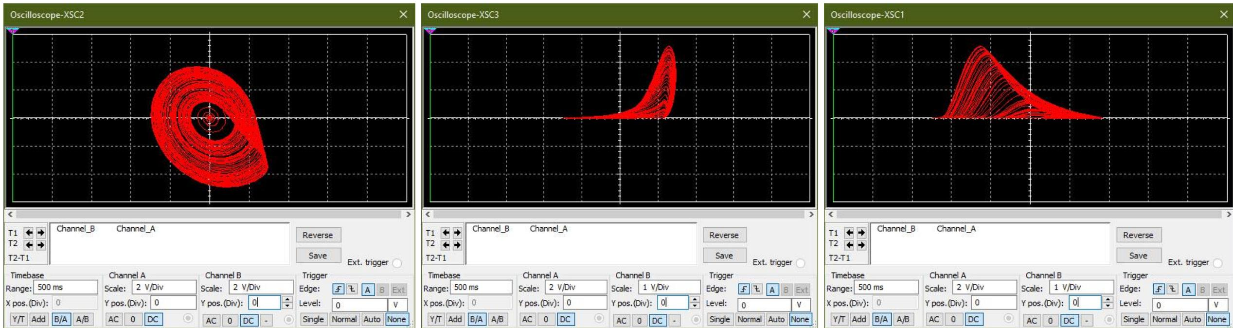
Atractores caóticos del sistema de Rössler (1V/Div): a) plano xy, b) plano xz, c) yz.
