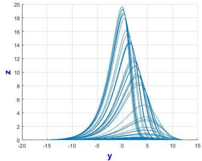
Método de integración de Runge-Kutta de cuarto orden,  $h=0.001$ ,  $t_{sim}=100$  segundos y condiciones iniciales:  $x(0) = y(0) = z(0) = (0.5, 1.5, 0.1)$ , Matlab R2020a ® en doble precisión, el tipo de error por redondeo y épsilon de máquina de  $2.2204e-16$ .
