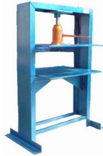
Prensa hidráulica manual Modelo 70/80, con bases de 700 mm x 800 mm, espesor de 3/8", plancha de 700 mm x 800 mm. Placa de 1/2" con gato hidráulico de 10 ton presión. Fuente: https://www.aceroarte.com
