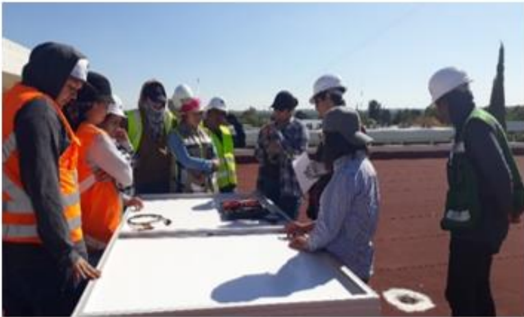
Ilustración 2. Medición de parámetros eléctricos en módulos. "Elaboración propia"
