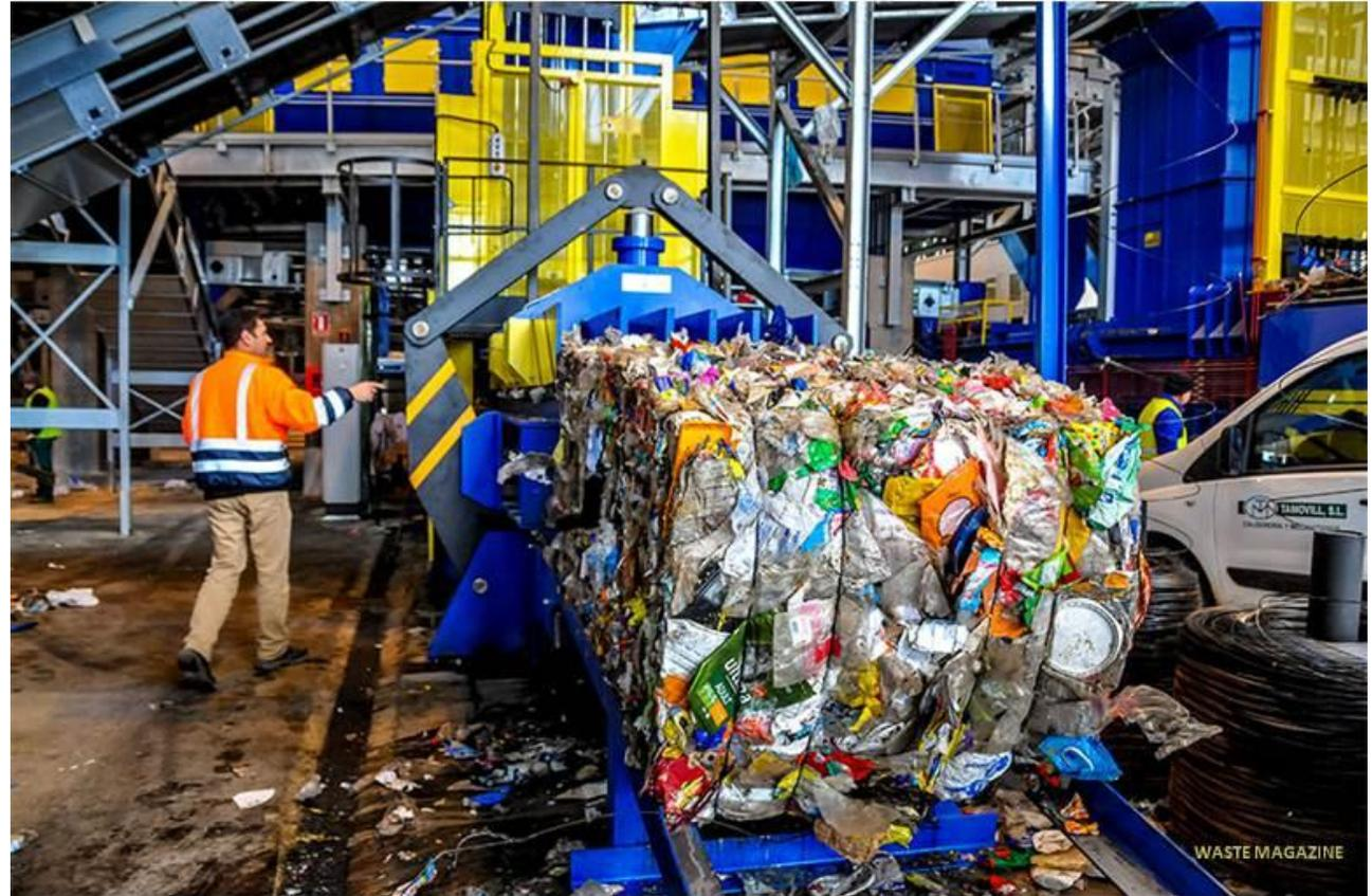
FIGURA 2A Separación manual de materiales plásticos
