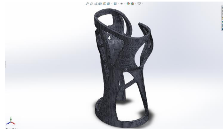
Figura 16. Diseño generativo reduciendo el 40% de la masa.
