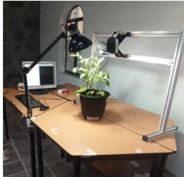
Figura 1 Hardware del sistema de captura de imágenes: cámara, lámpara y raspberry pi 3.
