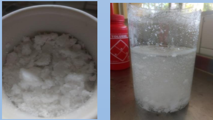
Figura 4. Lavado, secado y cristalizado del oligómero derivado de alcoxi benzoatos y haluros de alquilo. Fuente propia
