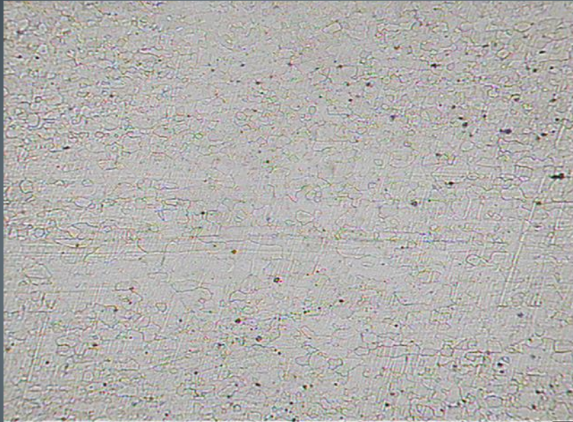
Microestructura a 100X del acero A. Se observan granos recristalizados
