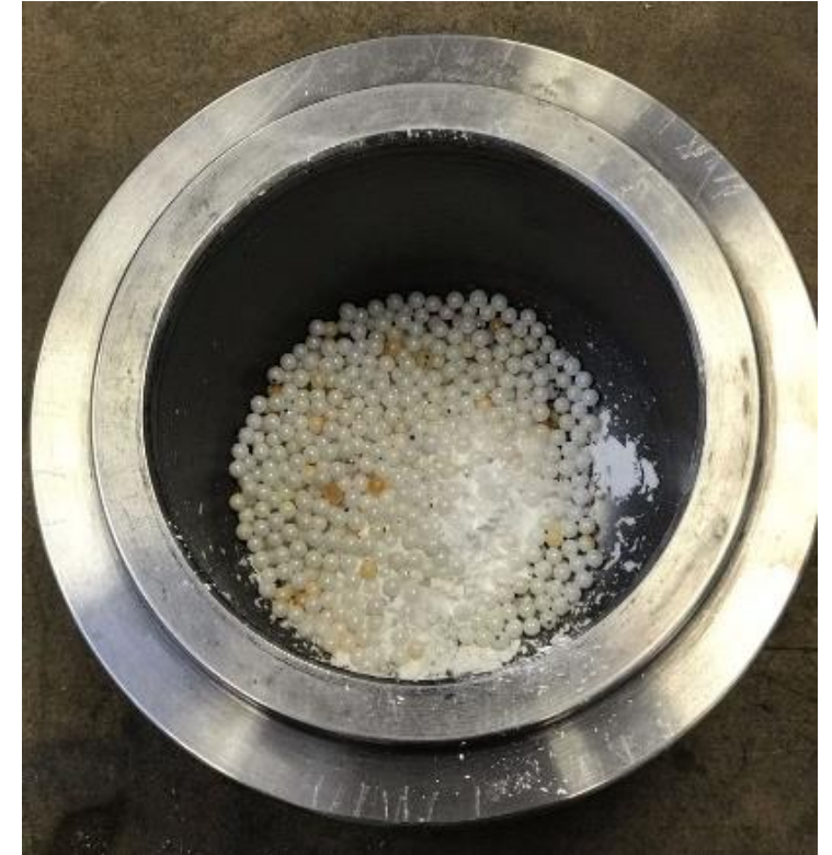
Figura 5.- Contenedor de acero con elementos de molienda.
