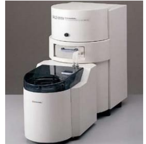
Figura 6.- Equipo para determinar la granulometría del polvo.
