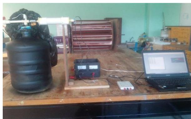
**Figura 1** Biodigestor, sensor y equipo de adquisición de datos
