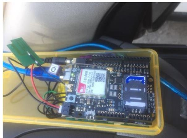
**Figura 7** Unidad a bordo del vehículo ya conectado
