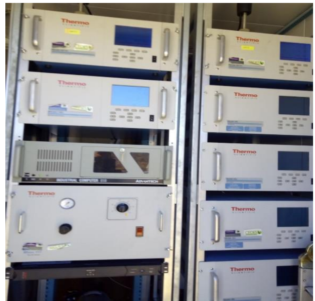
Figura 1 Equipo de Muestreo de estación de monitoreo de calidad del aire
