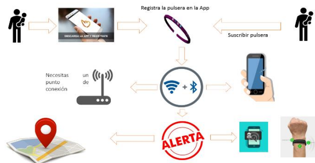
Figura 1 Arquitectura general del funcionamiento del gadget localizador o pulsera “AyTá”
