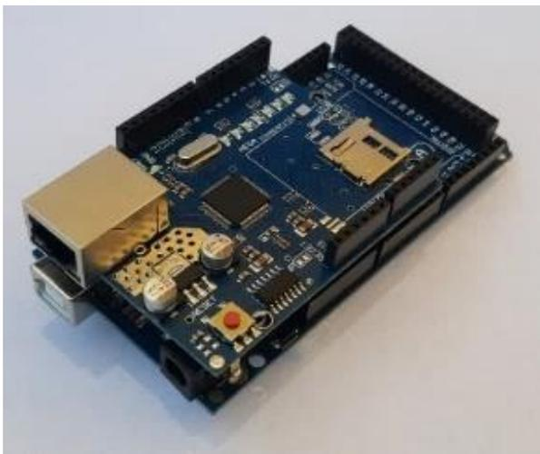
Figura 3 Tarjeta Arduino con Modulo Ethernet
