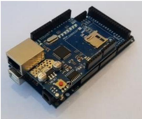
**Figura 3** Tarjeta Arduino con Modulo Ethernet
