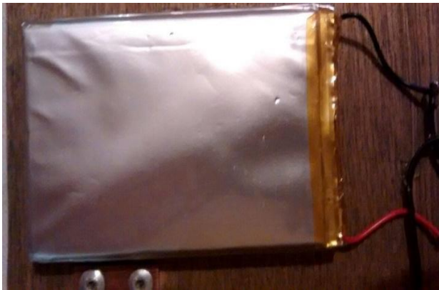
Figura 2 Batería de litio
