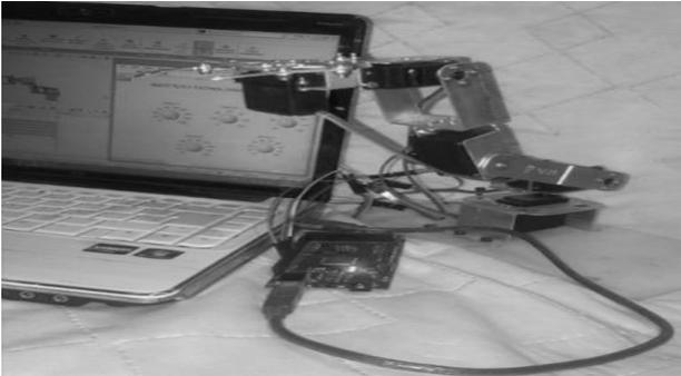
**Figura 8** Manipulación del robot desde la interfaz.
