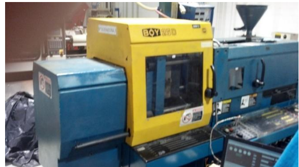
Figura 3 Máquina de Inyección de plásticos BOY 25D.
