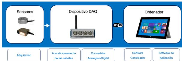
**Figura 4** Diagrama de bloques de los elementos que integran el sistema.
