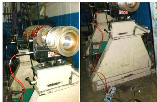
**Figura 11** Máquina balanceadora con los acelerómetros instalados.
