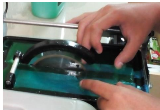
Figura 1 Proceso de cortado de los vidrios.
