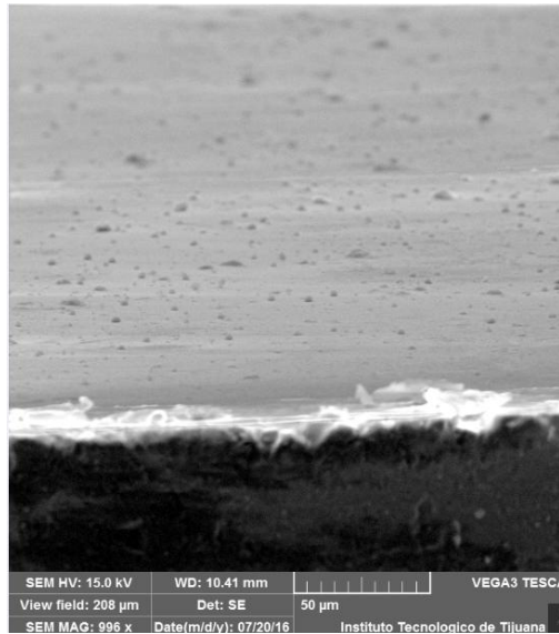
Figura 7 Imagen del microscopio SEM en la que se muestra una imagen transversal del sustrato con dióxido de titanio, la parte inferior oscura es la parte transversal del vidrio.
