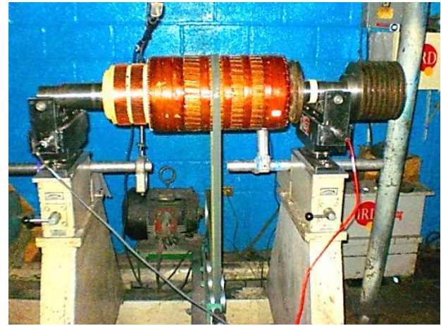
Figura 13 Balanceo de rotor de prueba.
