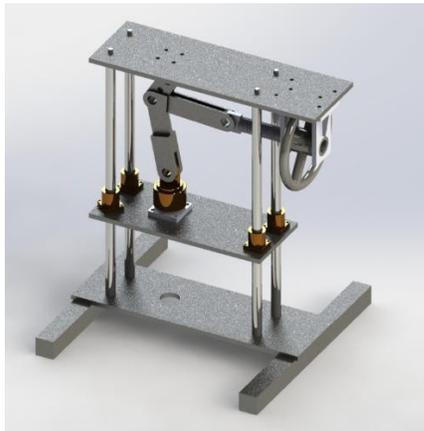
**Figura 10** Dibujo en SolidWorks de la prensa
