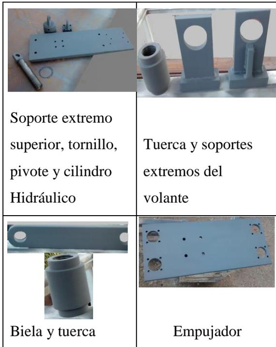
**Figura 13** Dibujo en SolidWorks de componentes de la prensa
