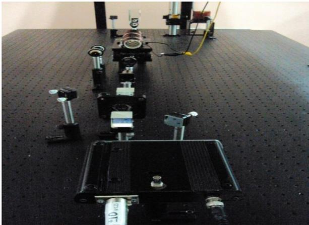
**Figura 8** Fotodetector Balanceado instalado en arreglo óptico
