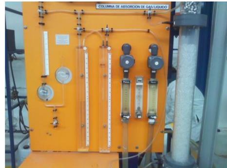
**Figura 1** Columna de absorción empacada
