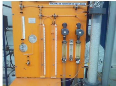
**Figura 1** Columna de absorción empacada
