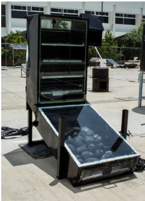
Figura 6 Deshidratador solar híbrido
