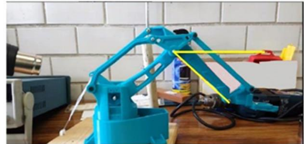
Figura 5 Actuación del músculo dentro de articulación de un manipulador serial
