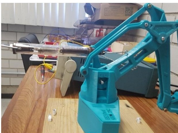
Figura 4 Prueba de fuerza en articulación con dinamómetro
