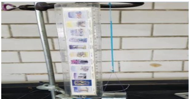
Figura 2 Músculo artificial de nylon sometido a carga
