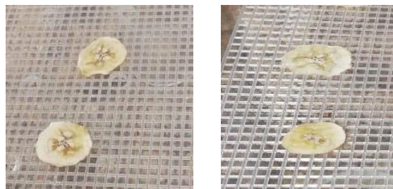
Figura 3 Cambio de color del plátano mediante el proceso de convección forzada
