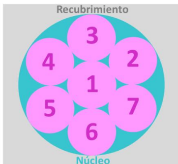
Figura 6 Arreglo espacial de siete fibras SM (círculos morados) conectadas al núcleo de la fibra MM que será utilizado en este trabajo
