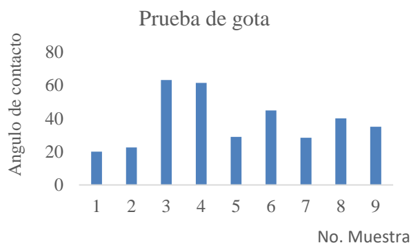
Grafica 5 Prueba de ángulo de contacto del biopolímero de sábila
