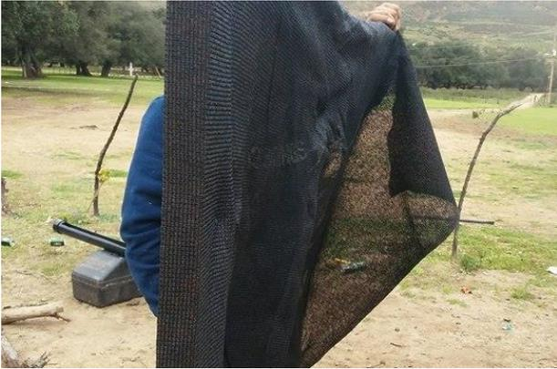
**Figura 8** Malla para captación de humedad
