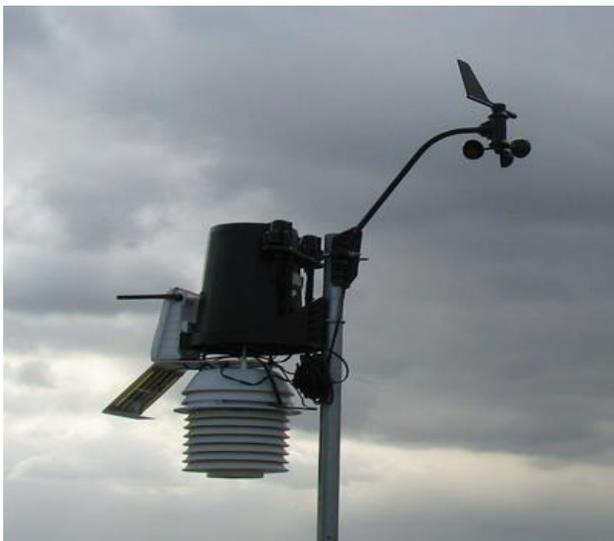
**Figura 14** Estación meteorológica Davis Vantage Pro2 6152
