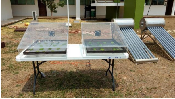
Figura 1 Secador solar directo tipo gabinete
