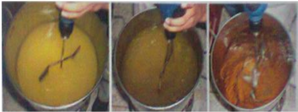
Figura 3 Cambio de aspecto del biodiesel debido al calentamiento
