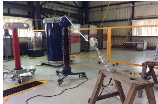
Figura 3 Fuente de voltaje utilizada en el método normal para medición de DP
