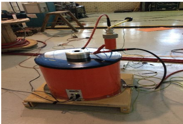
Figura 5 Fuente de voltaje utilizada en el método oscilante para medición de DP
