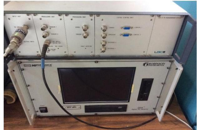
**Figura 2** Equipo de medición de DP
