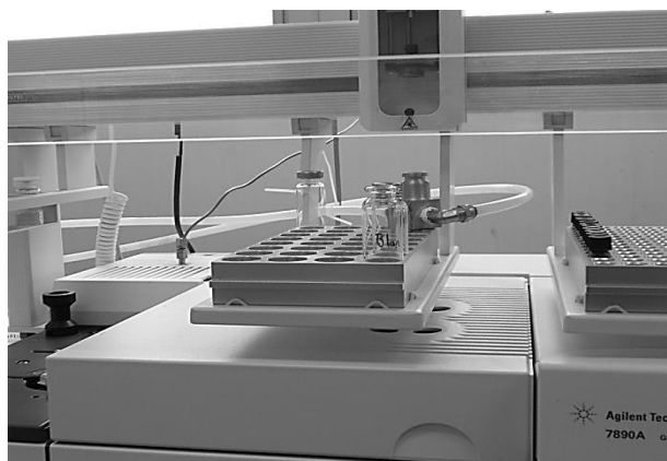
Figura 4 Vial metálico colocado sobre la charola de automuestreo
