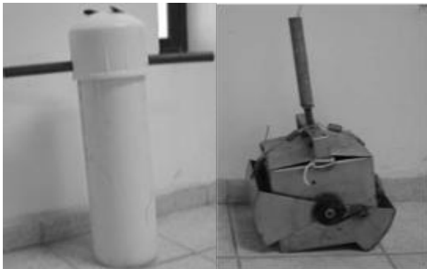
Figura 5 Técnicas de muestreo de sedimentos superficiales: Nucleador y Draga
