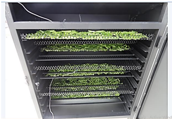
Figura 4 Cámara de secado. Fuente J. Torres
