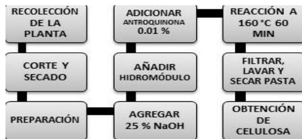
**Figura 1** Diagrama de flujo del proceso de extracción de celulosa
