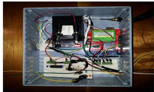
**Figura 7** Interior del módulo de adquisición de datos
