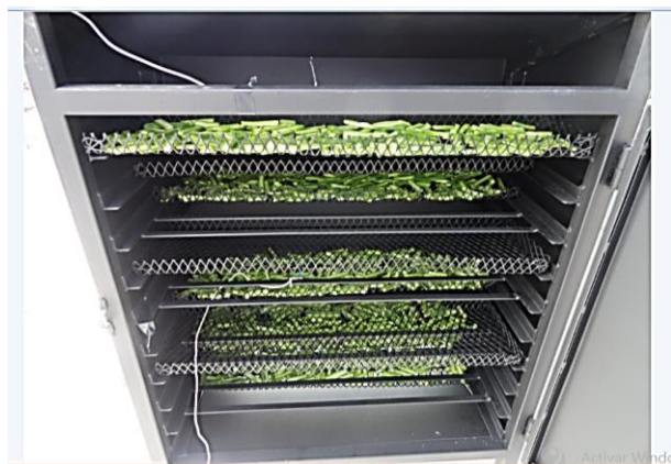
Figura 4 Cámara de secado. Fuente J. Torres
